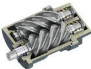
Особое внимание компания COAIRE уделяет качеству винтовых блоков. Строгий контроль качества на всех этапах производства обеспечивает идеальную согласованность работы деталей винтового блока. Длительный ресурс винтовой пары – 100 000 часов – достигается за счёт низких оборотов, трехрядного усиленного подшипника, двойного и тройного сальника для большей герметичности.
