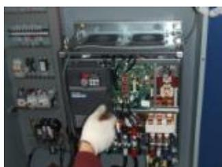
Блок частотного регулирования позволяет компрессору автоматически регулировать обороты двигателя в зависимости от потребности в сжатом воздухе в течение рабочего времени. Таким образом, частотное регулирование позволяет значительно экономить расходы на электроэнергию, что особенно актуально на производствах, на которых происходит переменное потребление сжатого воздуха в течение рабочей смены.
